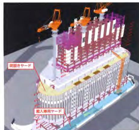
施工BIMによる計画の検証
