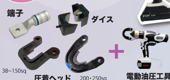
工具本体は共通で、端子の種類(圧縮/圧着)によってダイスとヘッドが変わります。
